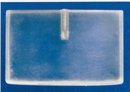
Figura 2 - Modelo finalizado, pronto para ser levado ao polariscópio.
