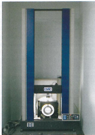
Figura 3 - Máquina de Ensaio Universal com polariscópio circular inserido
